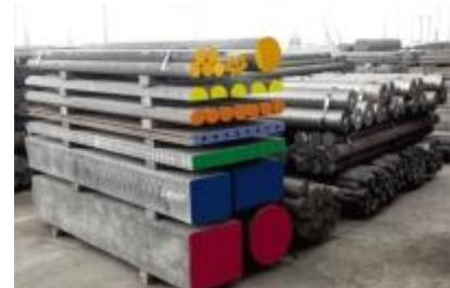
La structure matricielle de la fonte grise coulée continue contient du graphite en flocons, et la structure matricielle varie de la perlite complète à la perlite plus ferrite selon la nuance. Le graphite en flocons est conforme au type ASTM VI et peut être produit en type D, taille 6-8 ou en type A, taille 4-6.
