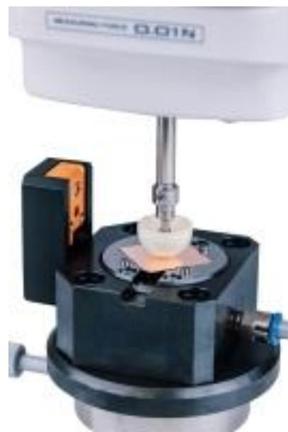
**Territoire d'innovation / Area of innovation :** Productivité : Innovation pour contrôler sans destruction les films de batterie. Contrôle laser de l'action d'aspiration. L'aspiration se déclenche lorsque le stylet hémisphérique se déplace dans la zone du capteur laser. - Le support de films est monté directement sur le LITEMATIC VL-50. - Il peut être utilisé pour la tête LITEMATIC VL-50S moyennant l'installation d'un adaptateur sur le marbre
